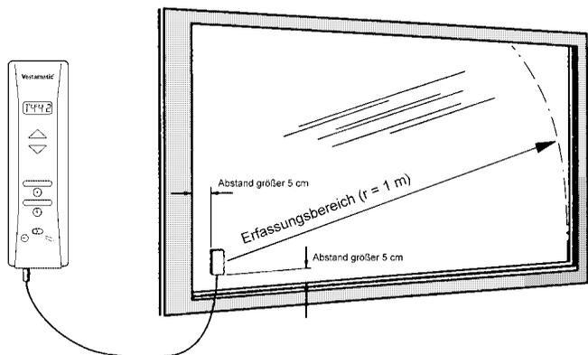
Für die Zusatzfunktion „Glasbruchmelder“ wird zu jeder Rolladensteuerung **Vestamatic® Rollmat Plus G/S V3.1** ein (bei größeren oder geteilten Scheiben mehrere) Glasbruchmelder benötigt. Im nachfolgenden Text wird beschrieben, wie die Installation durchgeführt wird.
